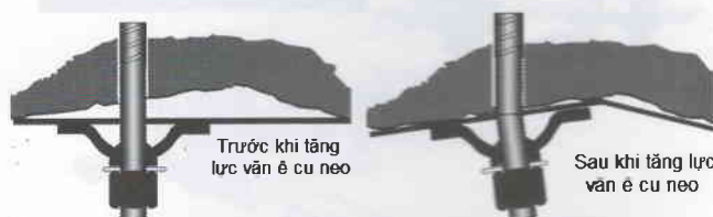
H.9. Hiện tượng thanh neo bị gãy gập khi tăng lực vận đai ốc neo
