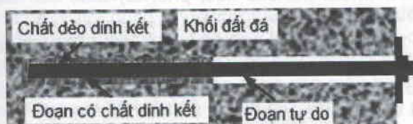
H.12. Cấu trúc trong lỗ khoan thân cốt neo thép đặc có chất dẻo dính kết
