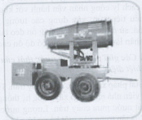
Hình 8. Thiết bị phun sương dập bụi áp suất cao loại 3WD 2000-60
