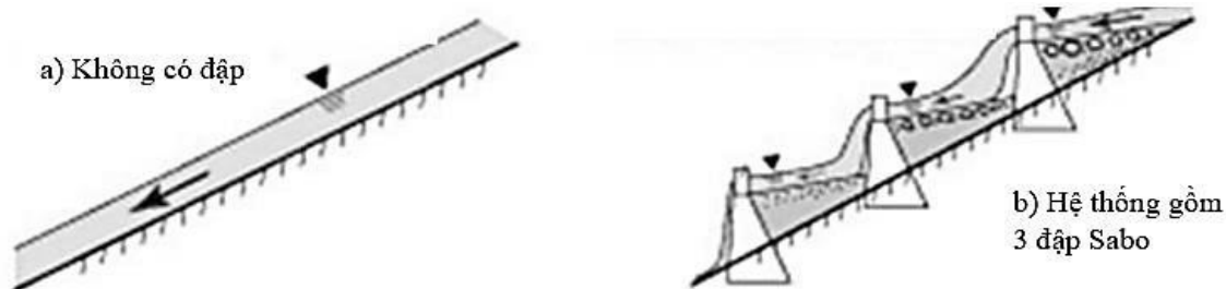
Hình 1. Tác dụng của đập Sabo trong phòng tránh lũ bùn đá (Wisoyo, 2012)
