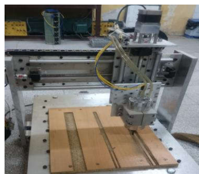
Hình 11. Máy chạy thử nghiệm phay gỗ
