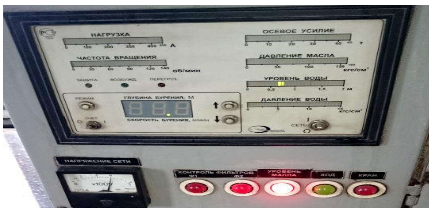
Hình 2. Bảng điều khiển - giám sát thông số quá trình khoan trong cabin
