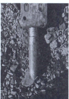
Рис. 1 Вид пика гидромолота JCB HM380 после эксплуатации
