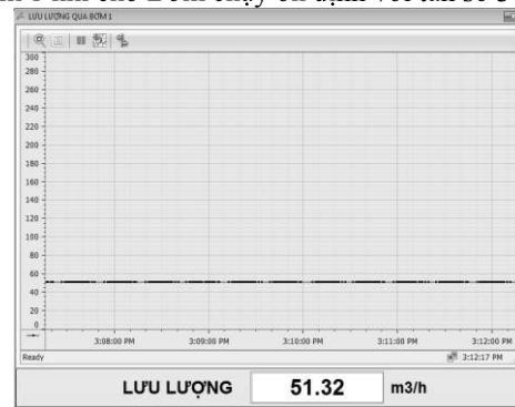
Biểu đồ thể hiện thông số áp suất và lưu lượng của Bơm 2 khi cho Bơm chạy ổn định với tần số 30Hz (Sử dụng archive tag).
