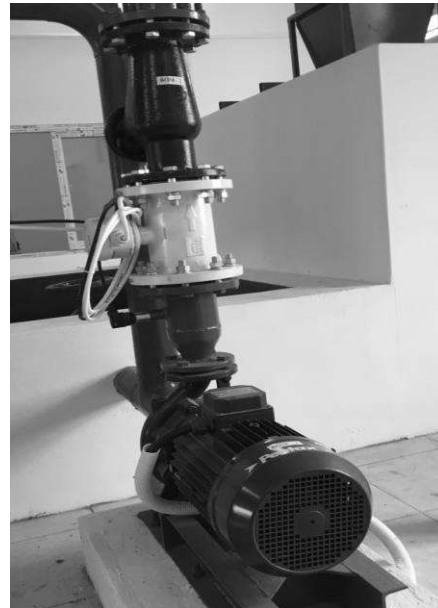
Hình 2. Vị trí lắp đặt các cảm biến lưu lượng và áp suất
