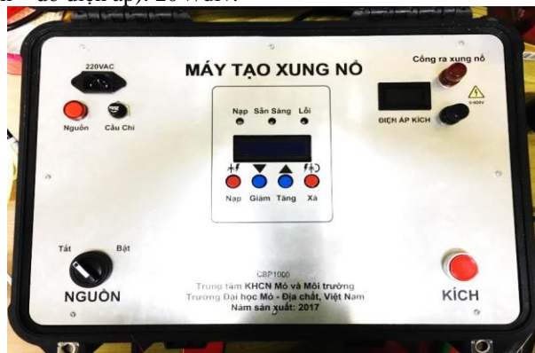
Hình 11. Sản phẩm thiết bị thử nổ bằng xung điện
