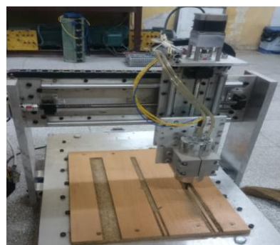
Hình 11. Máy chạy thử nghiệm phay gỗ
