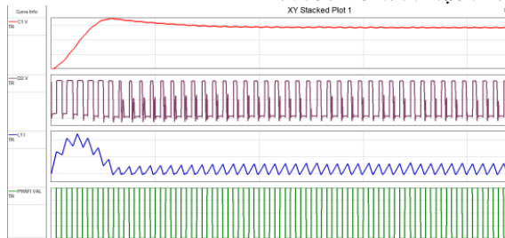
Hình 10. Dạng sóng điện áp trên các phần tử của mạch
