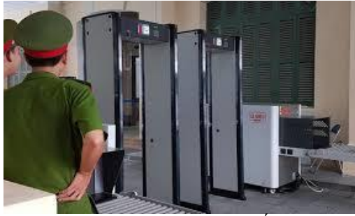
Hình 14. Ứng dụng cổng từ phát hiện kim loại theo vùng kết hợp với máy soi chiếu hành lý Xray trong hệ thống mạng kiểm soát an ninh
