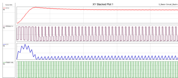
Hình 7. Dạng sóng điện áp trên các phần tử của mạch
