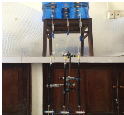
Hình 1. Hệ thống xử lý các hợp chất của Nito trong nước thải
