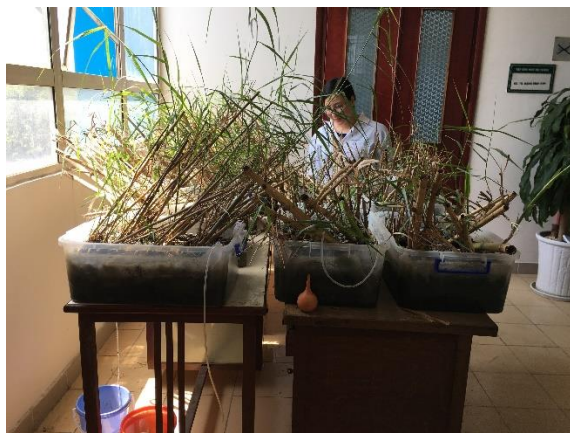
Hình 3. Mô hình Wetland trong nghiên cứu (có bổ sung vật liệu sinh học tự nhiên)
