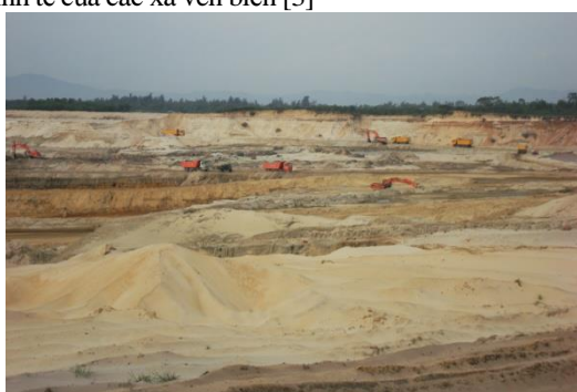
Ảnh 1: Mỏ khai thác sắt Thạch Khê có độ sâu hơn 40m, được bơm hút tháo khô nên mực nước ngầm trong khu vực hạ thấp
