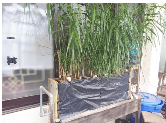
Hình 2. Hệ thống SSF-CW được trồng Phragmites australis sử dụng cho xử lý nước thải sinh hoạt
