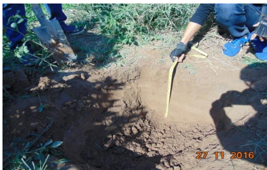
Hình 1. Phẫu diện đào 80cm x 80cm hệ tầng Thái Bình, huyện Gia Lâm, Hà Nội
