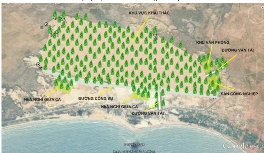
Hình 5. Mỏ quặng sa khoáng Titan - Zircon tại xã Hồng Phong và xã Hòa Thắng sau khi cải tạo phục hồi môi trường (Nguồn: Báo cáo ĐTM mỏ quặng sa khoáng Titan - Zircon tại xã Hồng Phong và xã Hòa Thắng)
