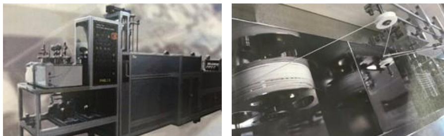
Hình 3. Hệ thiết bị chế tạo màng lọc sợi rỗng tại Trung tâm AMT
