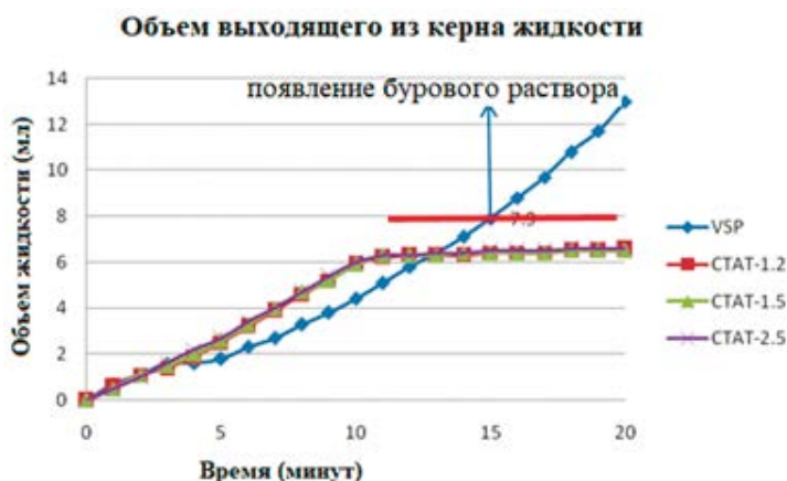
Рис. 4. Изменение во времени объема жидкости, выходящей из керна (при 10,8 МПа; 120 °С).
