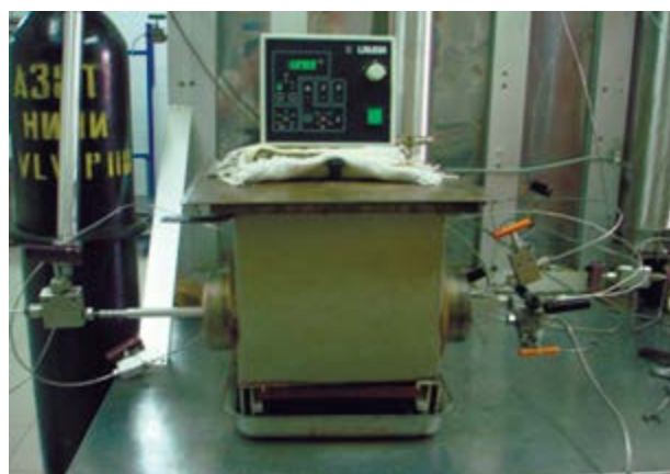
Рис. 3. Камера для обжатия и удержания керна.
