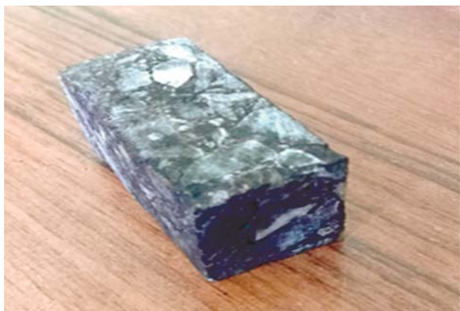
Рис. 1. Стандартный образец кернового материала битуминозного месторождения «Yegbata» (Нигерия), подготовленный к испытаниям на приборе УИПК-1.
