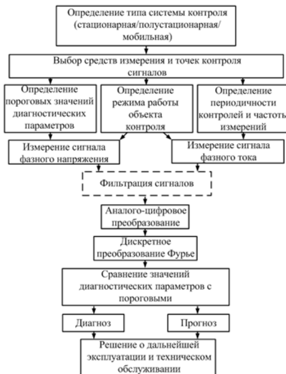
Рис. 2. Порядок электропараметрического контроля технического состояния оборудования.
