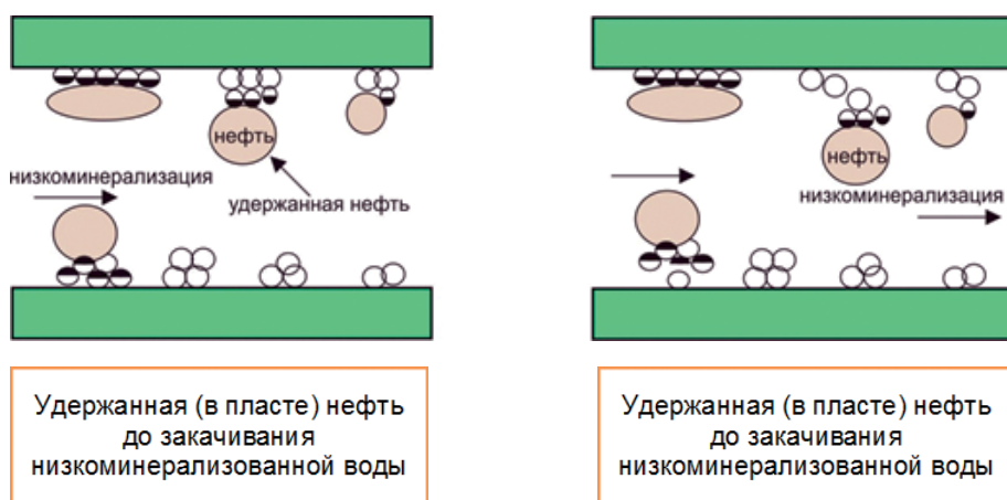
Рис. 2. Мобилизация захваченной нефти за счет миграции мелких частиц [2].
