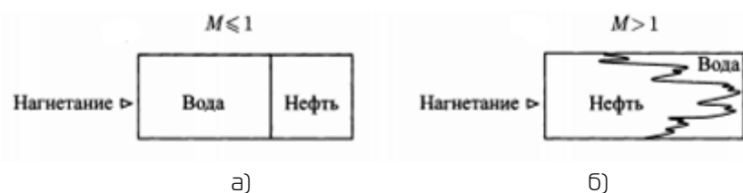
Рис. 5. Пример линейного заводнения в однородном образце керна.
