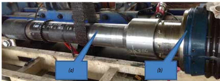
Thiết bị treo cần khai thác (a) và thiết bị kết nối (b)
