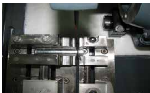
Hình 3. Bộ khuôn đúc mẫu thử nghiệm
