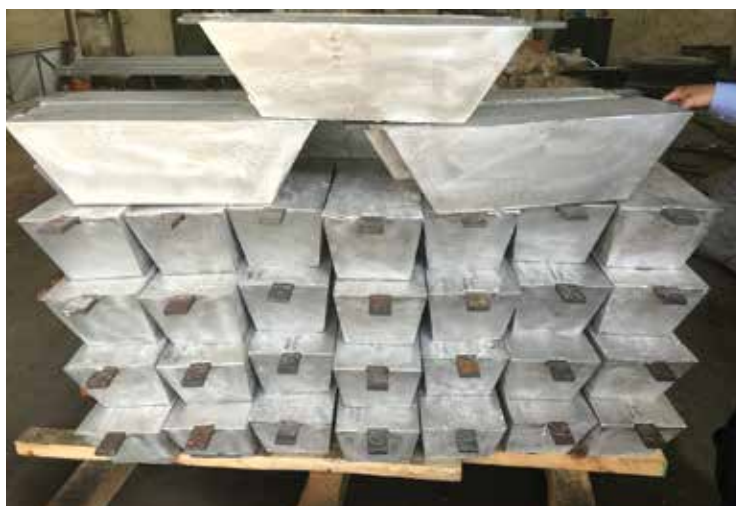
Hình 5. Anode hy sinh hợp kim kẽm sau khi đúc
