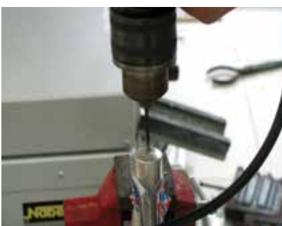
Hình 4. Mô tả quá trình gia công mẫu thử nghiệm
