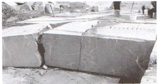
Hình 2. Tách khối từ khối lớn sau cắt bằng dây kim cương và cưa đĩa bằng nêm tại mỏ Chũr Quê, Thừa Thiên Huế
