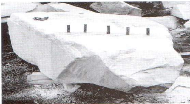
Hình 1. Công tác tách khối từ đá tầng lẫn tại mỏ Kim Sơn, Phú Yên
