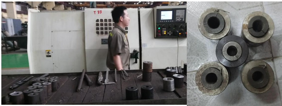
Hình 4. Gia công chế tạo Vành đỡ và Nêm chốt tại Công ty VMIC
