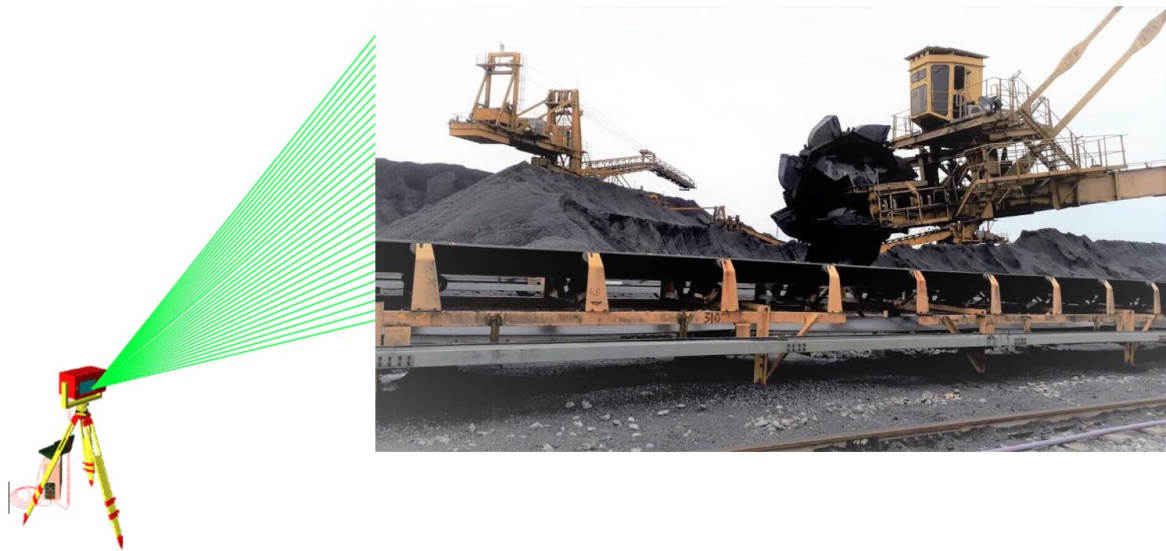
Hình 1. Mô phỏng quy trình quét laser 3D trên thực địa
