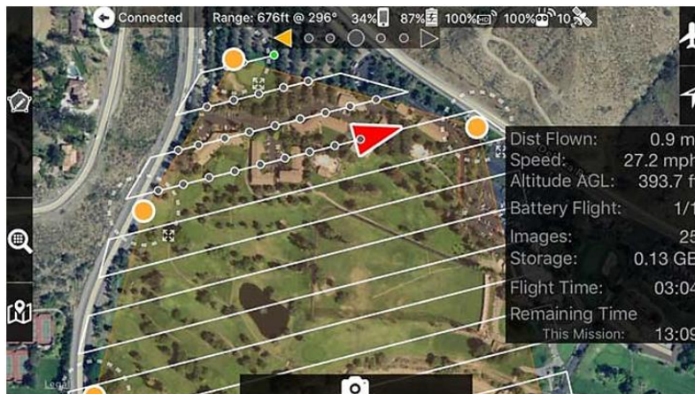
Hình 4. Đồ hình bay được thiết kế bằng phần mềm Map pilot.
