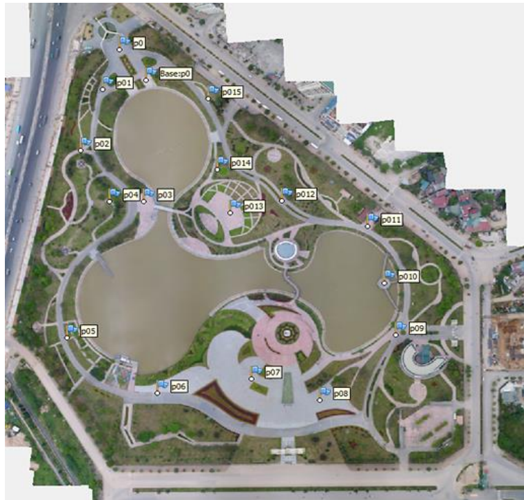
Hình 2. Sơ đồ bố trí điểm khống chế mặt đất.
