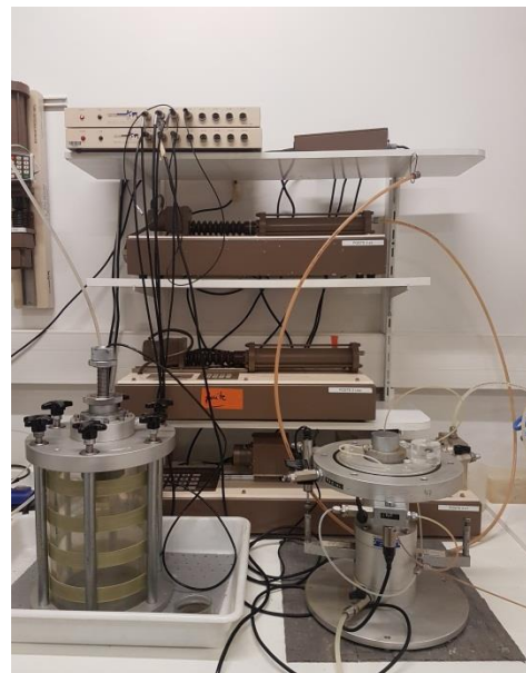
Hình 2. Thiết bị nén ba trục dạng Bishop và Wesly
