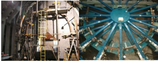
Hình 2. Mô hình kiểm định chịu lực vì chống thép loại đứng và nằm ngang
