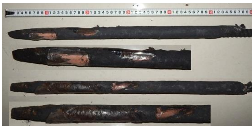
Hình 6. Hình dạng phá hủy của đoạn cố định đầu neo có đường kính 18mm
