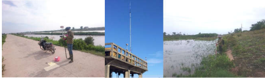
Hình 5. Công tác đo RTK-GNSS khống chế ảnh và đo bổ sung địa hình
