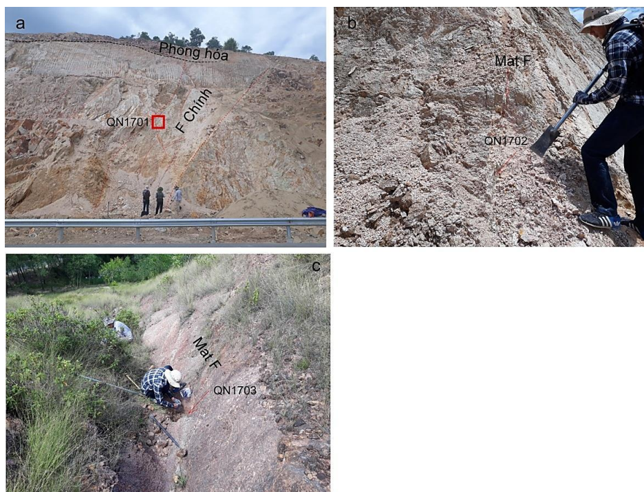
Hình 3. Ảnh các vết lộ thể hiện đứt gãy và vị trí lấy mẫu (a) Vị trí mẫu QN1701 thể hiện đới mùn đứt gãy cắt qua lớp phong hóa phía trên và các đường đứt gãy cắt qua đới mùn, (b) và (c) Vết lộ và vị trí lấy mẫu QN1702, QN1703
