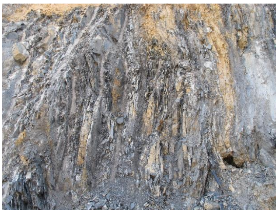
Ảnh 1. Đới vỏ nhàu dập vỡ chứa quặng đồng mỏ Đồng Bua
