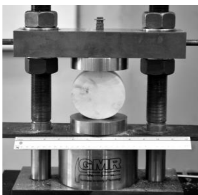
Hình 6. Xác định cường độ kháng kéo theo phương pháp gián tiếp, thông qua thí nghiệm Brazilian
