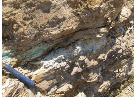
Ảnh 4. Các lớp bột kết, cát kết hạt nhỏ có thắm đọng các khoáng vật đồng thứ sinh, thể nằm dốc thoải cạnh đồi vò nhàu dập vỡ chứa quặng ở mỏ Khuôn Mươi.
