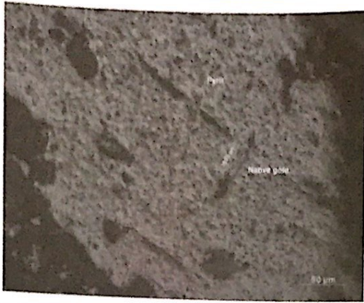
Ảnh 3. Hạt vàng tự sinh (kích thước 35,23 μm) lấp theo khe nứt nằm trong nền pyrit; KT-02-01; 300 x khu Vàng Tat [2]
