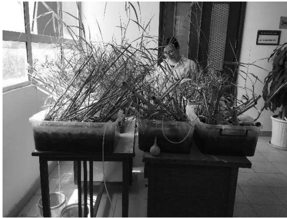
Hình 3. Mô hình Wetland trong nghiên cứu (có bổ sung vật liệu sinh học tự nhiên)
