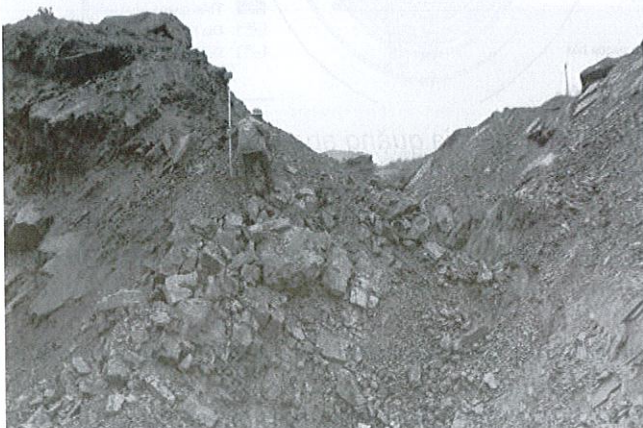
Ảnh 2. Triển khai đo vẽ địa hình và cập nhật gương tầng khai thác [7]
