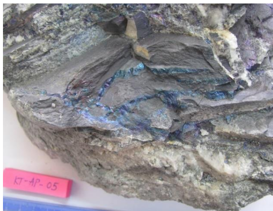
Ảnh 13. Chalcocit tạo mạch trong đá phiến sét-vôi mỏ Góc Sáu (Anh Phong)
