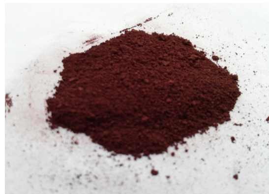
Hình 2.5. Sản phẩm phụ sau hòa tách (bột oxit sắt)
