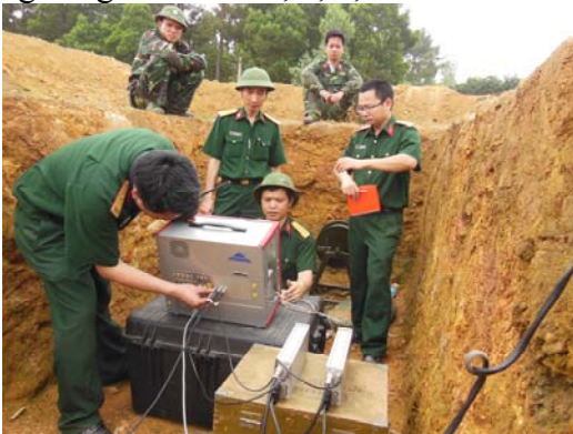
Hình 5. Ảnh hầm bố trí hệ thống nhận và phân tích tín hiệu đo
