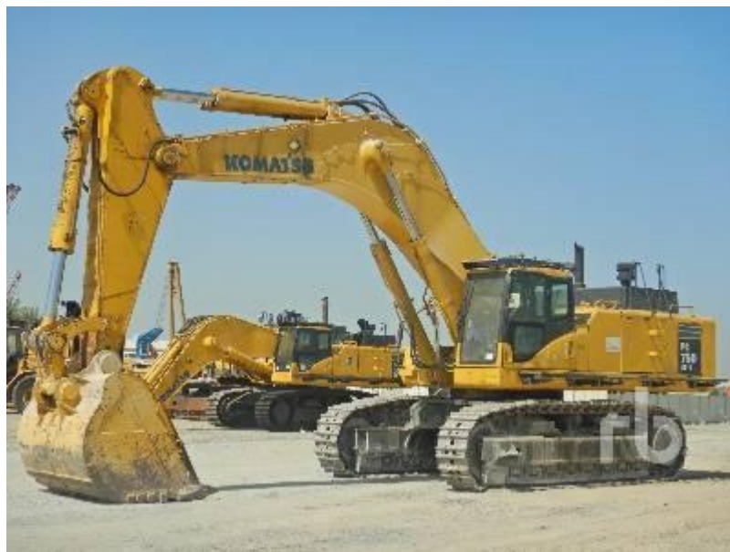
Hình 2.1 máy xúc thủy lực gàu ngược loại Komatshu PC750
