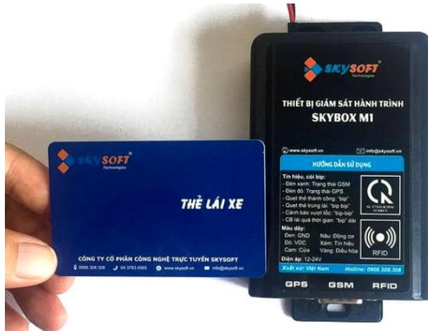
Hình 3.4. Thiết bị giám sát hành trình Skybox M1 do Skysoft sản xuất
