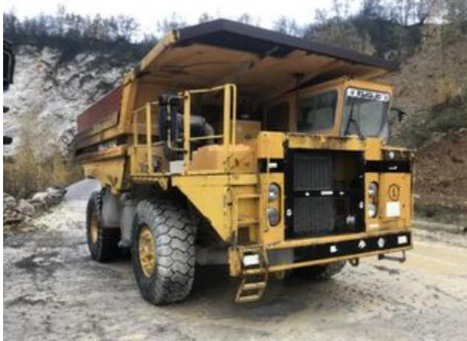
Hình 2.2 xe ô tô Euclid R32 (tải trọng 32 tấn, dung tích thùng xe 15 m 3 )
