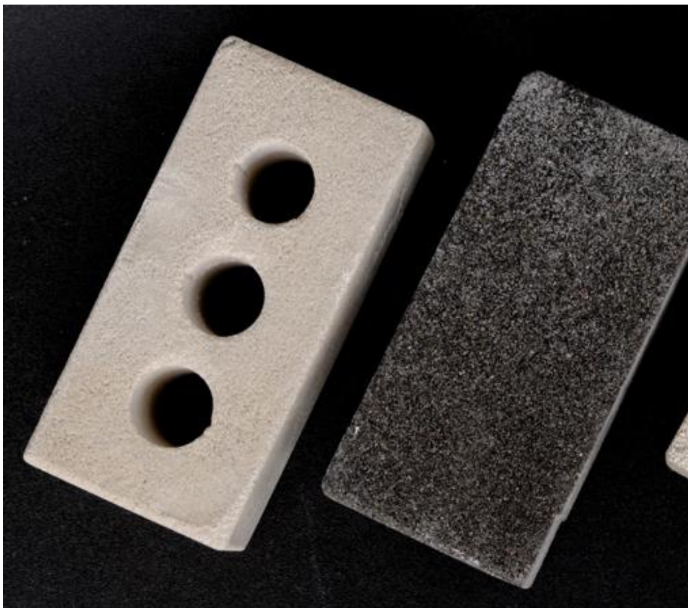
Các giải pháp sản xuất sử dụng vi khuẩn để 'phát triển' xi măng bền vững
