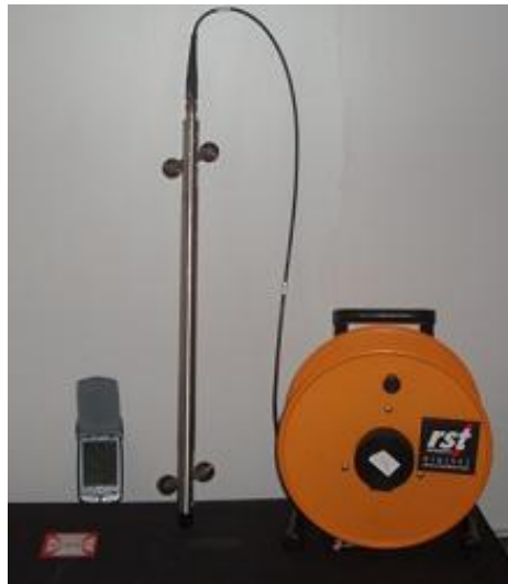
Hình 2.11: Đầu đo chuyển vị điện tử STS 1.701 & cuộn dây
