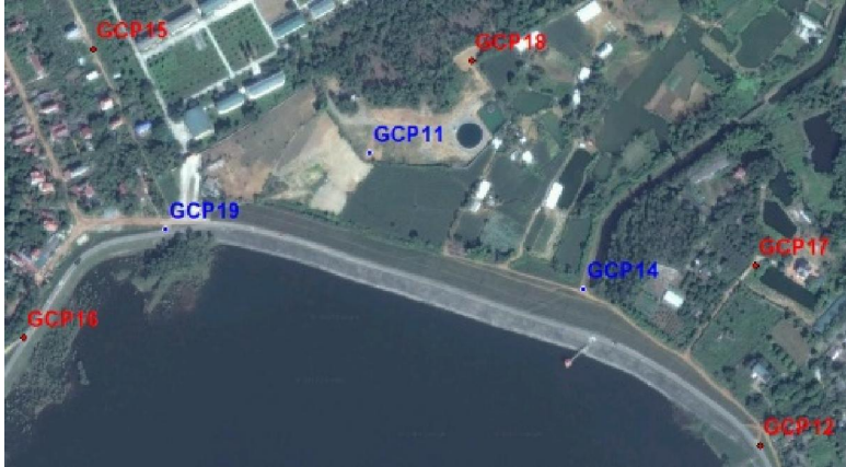
Hình 5.15: Bố trí điểm khống chế mặt đất (a) và tiêu đo khống chế (b)
