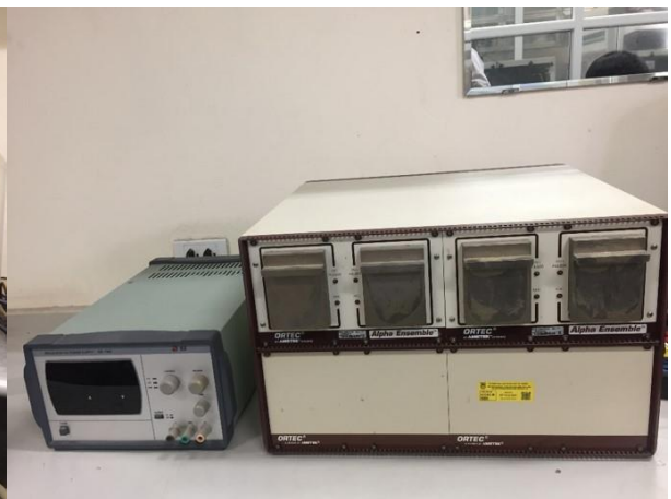
Hình 2. Hệ phổ kế Alpha 4 đầu dò (detector)(Alpha Ensemble-4 – Ortec-Ametek (Hoa Kỳ)) tại khoa Địa chất, Trường Đại học Khoa học Tự nhiên
