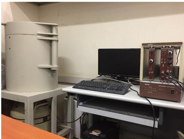
Hình 1. Hệ phổ kế Gamma phòng thấp (GEM50P4-70 – Ortec-Ametek, Hoa Kỳ) tại khoa Địa chất, Trường Đại học Khoa học Tự nhiên
