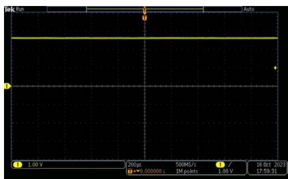
H.11. Đồ thị dạng xung ứng với độ rộng xung 100% và điện áp áp ra trên tải
