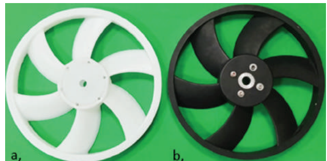
H.3. Hình ảnh (a) quạt đúc ly tâm và (b) quạt đối chứng
