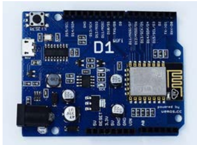
Figure 2. WeMos D1 R1 Pinout.
