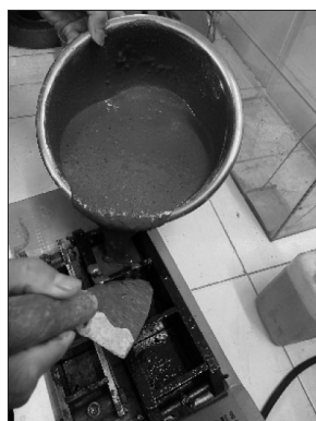
Рис. 5. Изготовление газобетонных образцов Fig. 5. Production of aerated concrete samples
