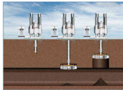
Hình 5. Mô hình công nghệ khoan doa ngược lên trên khi đào lò dốc (máy khoan ở mức thấp)
