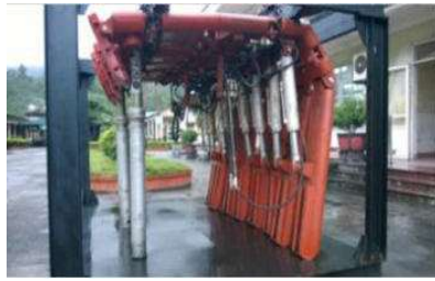
Hình 2. Cấu tạo của giàn chống mềm ZRY
