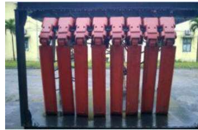
Hình 2. Cấu tạo của giàn chống mềm ZRY
