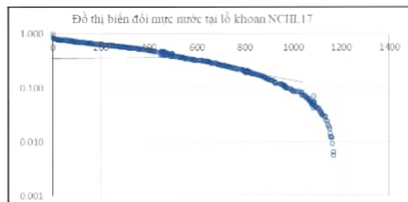
Hình 6: Đồ thị biến đổi mực nước ht/ho theo thời gian lần 1 tại lỗ khoan NCHL17
