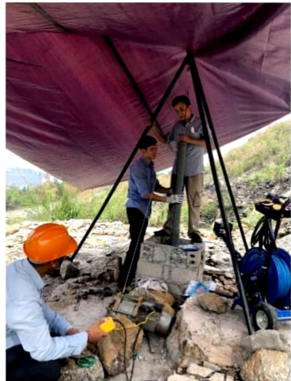
Hình 5: Quá trình thả và rút thanh slug khỏi lỗ khoan
