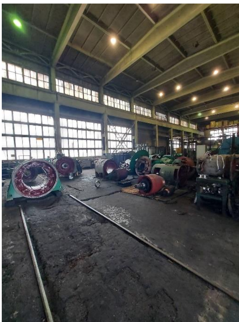
Рисунок 1 – Слесарный участок по разборке и сборке электрических двигателей
