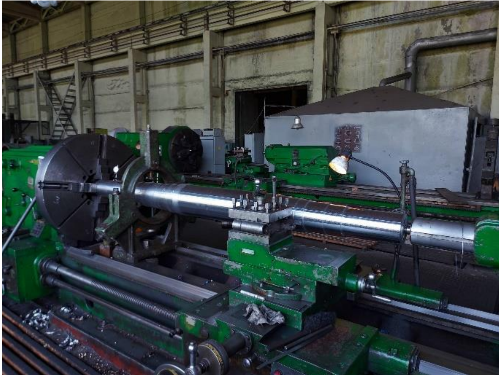
Рисунок 2 – Токарный участок проточки коллекторов и выточки новых валов
