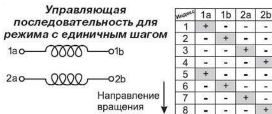
Рисунок 2 – Последовательность управления для режима с единичным шагом
