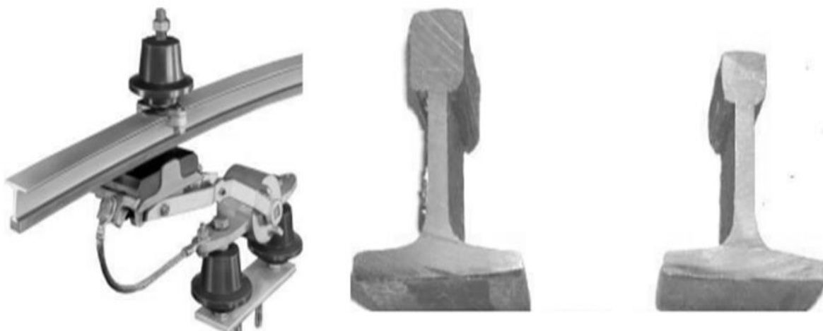
Рисунок 1 – Пример конструкции системы токосъема
