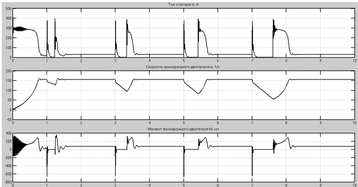
Рисунок 2 – Переходные процессы по току, скорости и моменту на валу асинхронного двигателя при пуске и четырёх отключениях питающего напряжения на разные промежутки времени
