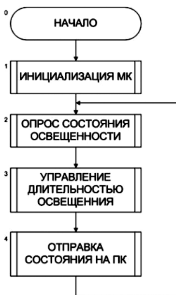
Рисунок 1 - Упрощенный вид алгоритма работы МК
