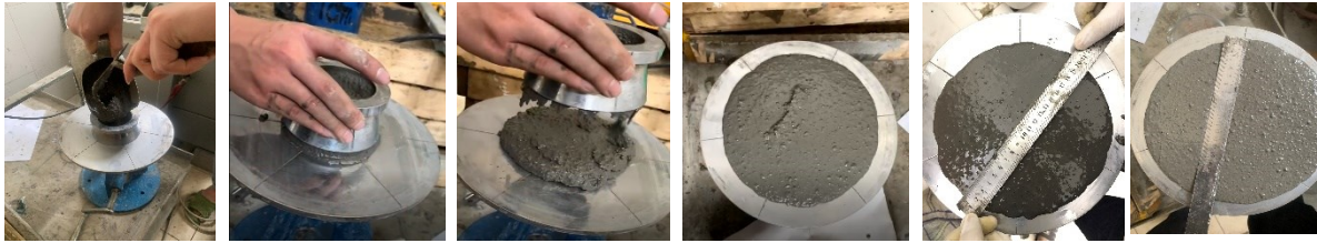
Hình 4. Xác định độ xòe của hỗn hợp bê tông cường độ cao hạt mịn trong cối vữa.
