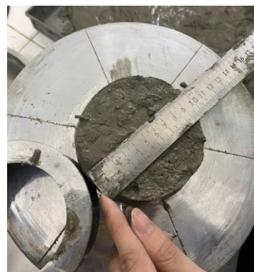
Hình 2. Bàn dẫn để xác định độ lưu động của hỗn hợp bê tông in 3D
