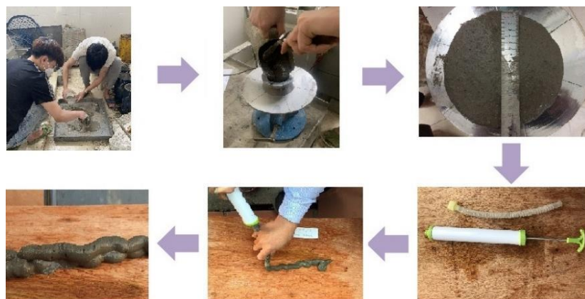
Hình 4. Quy trình trộn hỗn hợp bê tông và thí nghiệm khả năng in của bê tông in 3D
