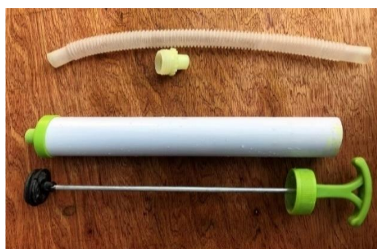
Hình 3. Thiết bị kiểm tra khả năng in của hỗn hợp bê tông
