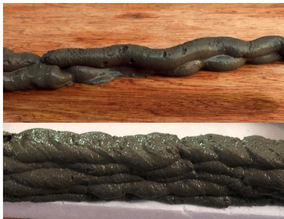
Hình 9. Sợi bê tông in ra liên tục, bề mặt bê tông không nhẵn mịn, giữ được hình dạng dưới trọng lượng bản thân và các lớp in chồng lên nhau
