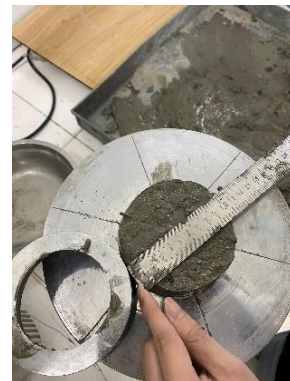
Hình 5. Xác định độ chảy của hỗn hợp bê tông in 3D trên bàn dần
