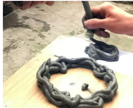
Hình 8. Quá trình in thử nghiệm để đánh giá khả năng in của hỗn hợp bê tông
