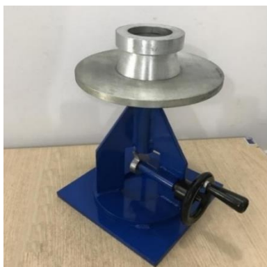
Hình 2. Bàn dẫn để xác định độ lưu động của hỗn hợp bê tông in 3D
