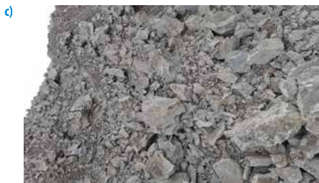
H.6. Một số hình ảnh về công tác thử nghiệm giải pháp nổ mìn giảm chấn động sử dụng đường kính lỗ khoan D = 160mm trên bờ trụ.
