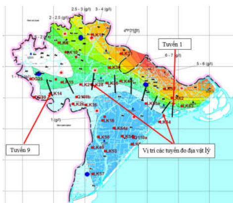
Hình 2. Vị trí các tuyến đo ĐVL bằng phương pháp đo sâu trường chuyển
