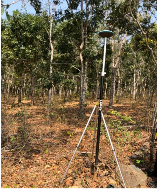
Hình 2. Đo chi tiết bằng RTK dưới tán cây xà cừ
