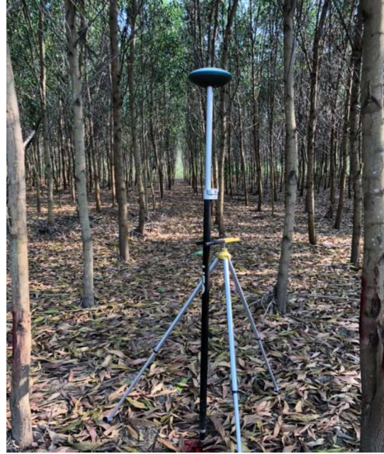
Hình 3. Đo chi tiết bằng RTK dưới tán cây keo lá trà
