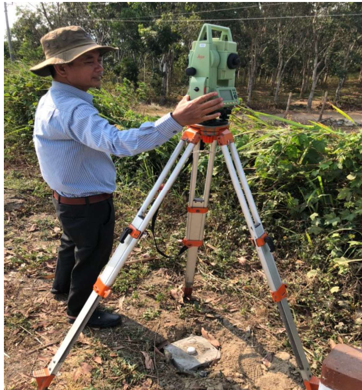
Hình 4. Đo chi tiết bằng máy toàn đạc điện tử tại điểm khống chế đo vẽ Tọa độ của 06 điểm khống chế đo vẽ được cho trong bảng 1:
