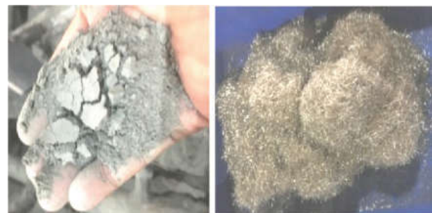
Hình 1. Vật liệu thành phần: (a) Hỗn hợp xi măng với phụ gia siêu dẻo có gốc Polycarboxylate; (b) Sợi thép cacbon của Cộng hòa Liên bang Đức
