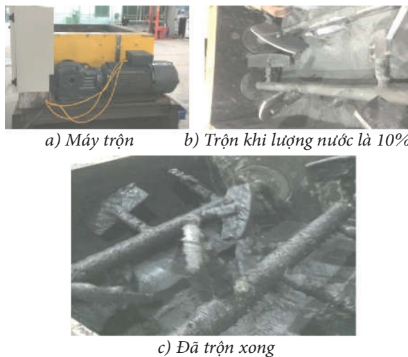
Hình 2. Máy trộn và quá trình trộn hỗn hợp bê tông
