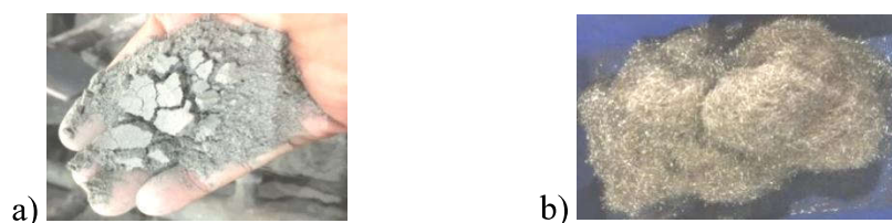
Hình 5. Vật liệu thành phần: a) Hỗn hợp xi măng với phụ gia siêu dẻo có gốc polycarboxylate; b) Sợi thép các bon của CHLB Đức
