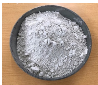
(б)- Доменный шлак металлургического завода «Хоа Фат»
