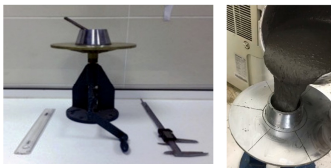
Рис. 8. Усеченный миниконус для определения расплыва бетонной смеси
