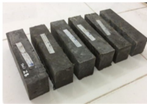
Рис. 7. Образцы-балочки из геополимерных бетонов
