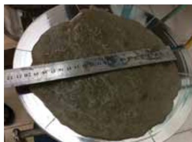
Рис. 5. Определение удобоукладываемости геополимерных бетонных смесей по РК
