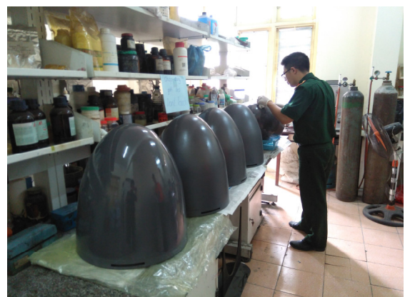
Cán bộ Viện HH-VL đang hoàn thiện vỏ chóp tên lửa Kh-35E.
