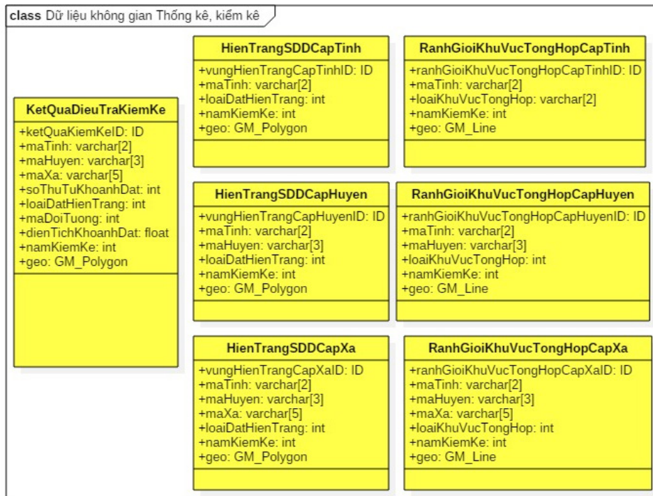
Hình 7. Sơ đồ lớp dữ liệu không gian thống kê, kiểm kê đất đai.
